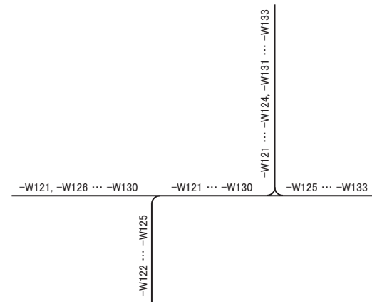
図9.18 ケーブルの組が単線で表されているケーブル線図の一部の例
