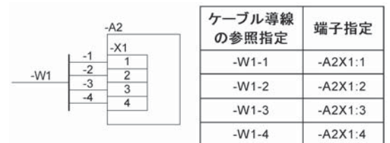
図9.2 複数導線からなるケーブルの終端の例
