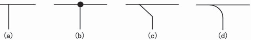
図6.38 T接続の電気用図記号
