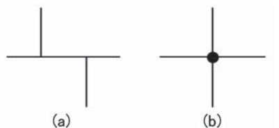
図6.42 二重接続の電気用図記号
